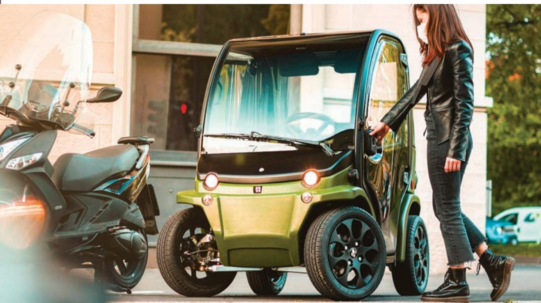
**È** il più piccolo veicolo a quattro ruote totalmente elettrico del mondo. Si chiama Birò la microcar prodotta da Estrima, progettata per offrire l'agilità di uno scooter nel traffico e nel parcheggio, ma con la protezione e la sicurezza di un'auto, e che può rappresentare un valido plus per le strutture ricettive. Larga un metro e lunga 1.74, è omologata per il trasporto di due persone; può circolare nelle Ztl, è esente dal pagamento delle strisce blu ed è au-
